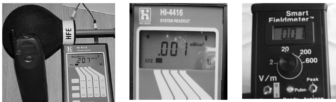
Εικόνα 2. Μέτρηση εκπεμπόμενης ακτινοβολίας από κινητό (αριστερά) σε \text{mW/cm}^2 σε σύγκριση με την ένταση της ακτινοβολίας του περιβάλλοντος σε χώρο απαλλαγμένο από ηλεκτρομαγνητική ακτινοβολία (κέντρο, σε \text{mW/cm}^2 ), (δεξιά σε βολτ ανά μέτρο).
