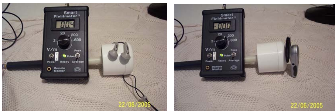
Εικόνα 5. Η ένταση της ακτινοβολίας που εκπέμπεται από το hands free (αριστερή εικόνα) κατά τη διάρκεια της συνομιλίας είναι πολύ μικρή (0,04 βολτ/μέτρο), ενώ από το blue tooth (δεξιά εικόνα) η εκπεμπόμενη ακτινοβολία είναι σχεδόν μηδενική.
